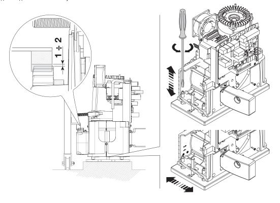
Переходите к креплению только после того, как будет отрегулировано расстояние между шестерней и зубчатой рейкой. Прикрепите автоматику к монтажному основанию стопорами и гайками.
