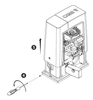
Установите автоматический привод на монтажное основание.
