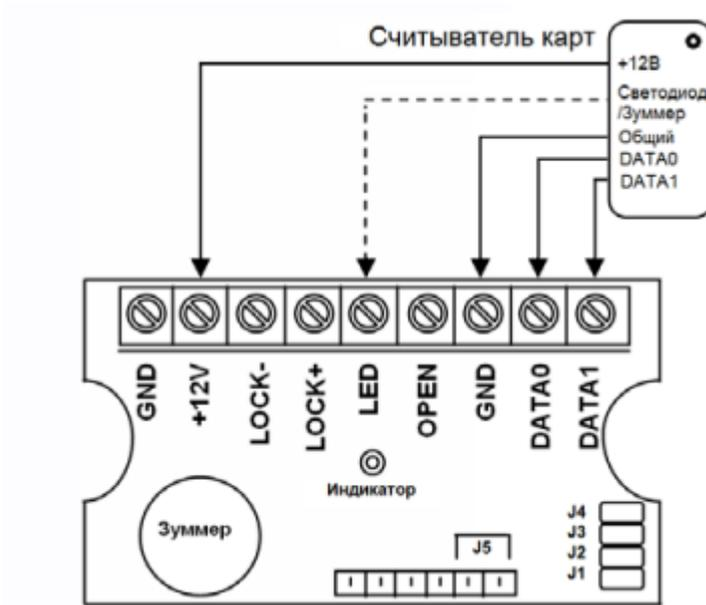
Рисунок 3. Общая схема подключения на примере OPTIMUS SK-01
