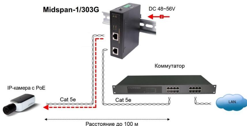
Рис.4 Типовая схема подключения инжектора Midspan-1/303G
