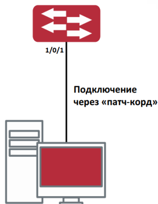
Рисунок 5. Управление коммутатором по Telnet
