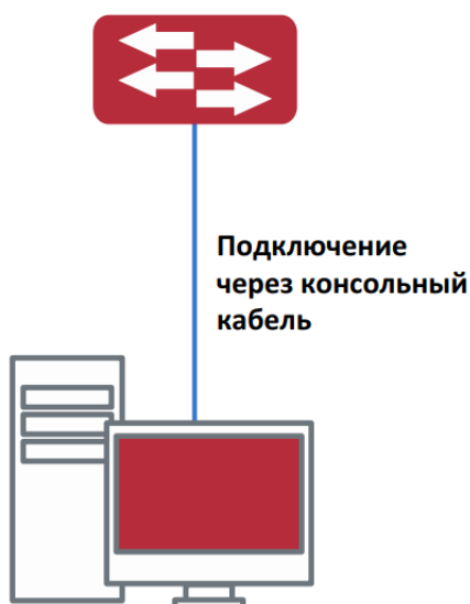
Рисунок 1. Подключение ПК к консольному порту коммутатора
