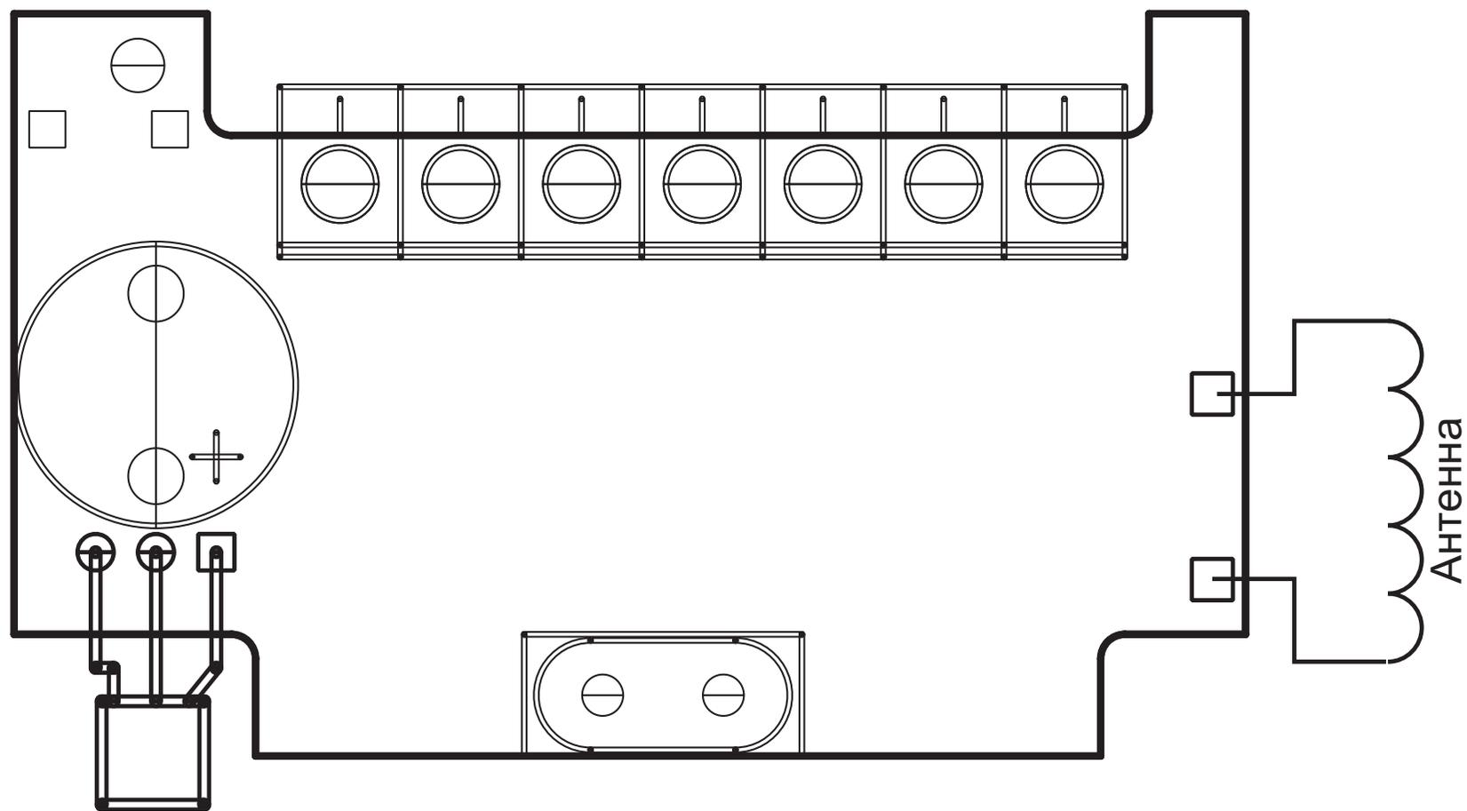
Высота выводов светодиода 13мм.
