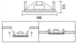
Подключение 70В линии оповещения <u>допускается</u>! При подключении громкоговорителя на 70В линию оповещения мощность громкоговорителя составит 3 Вт.
